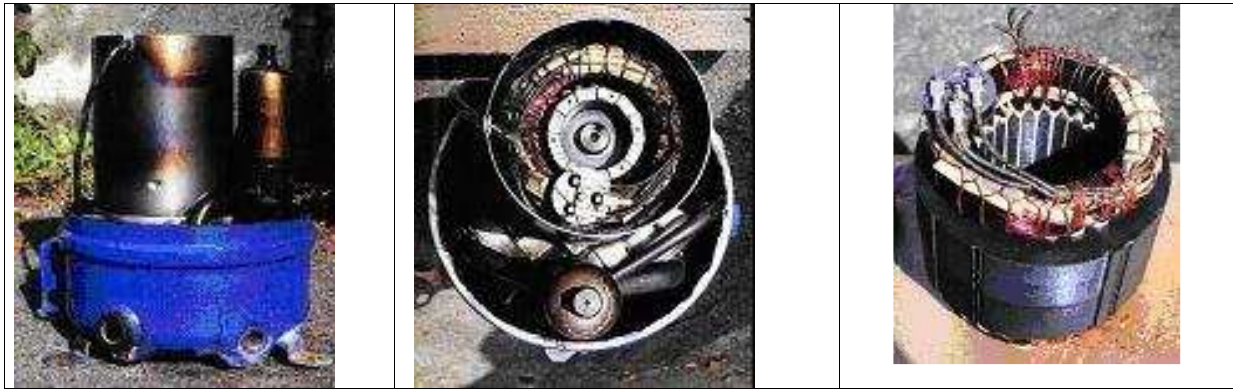
Figure 3.11 : Vues éclatées du compresseur avec le moteur électrique.
