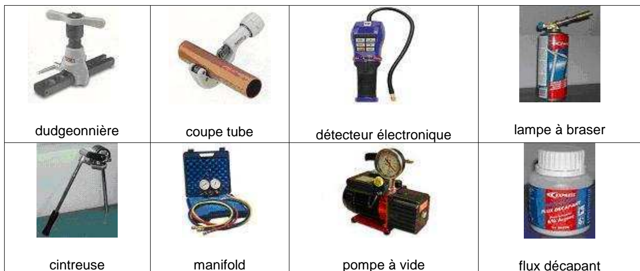
Figure 9.0 : Quelques outillages du frigoriste.
